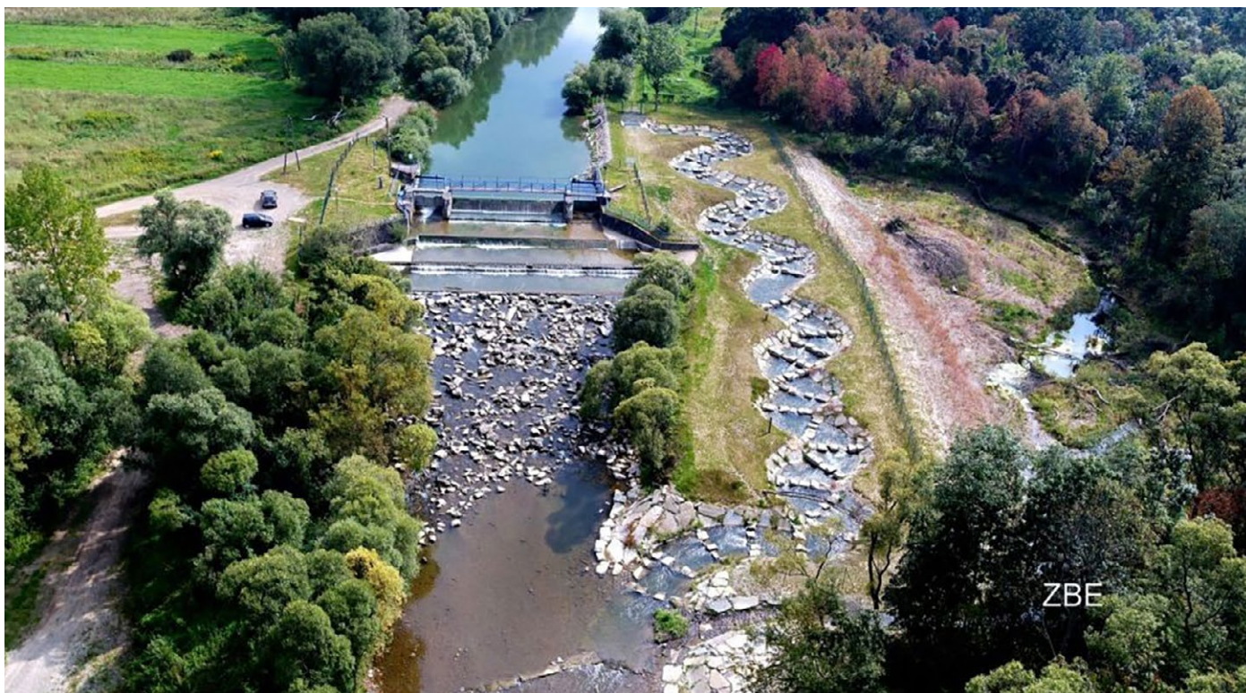
FOT. nr 21 – przepławka seminaturalna w m. Szczepańcowa na Jasiołce – dopływie Wisłoki. Fot. Państwowe Gospodarstwo Wodne Wody Polskie (Źródło: https://www.wody.gov.pl/images/Aktualnosci/01_12_21_Przepławki_Wisloka/Szczepacowa.jpg )
